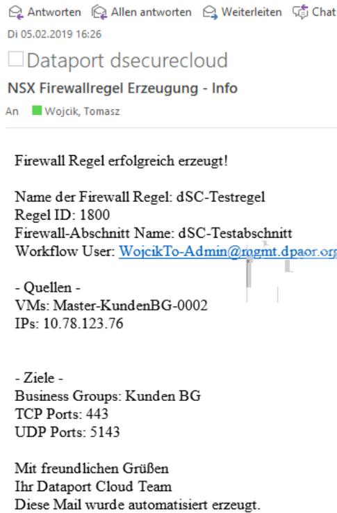
Abbildung 72 - Firewall Service - Bestätigung der Umsetzung
