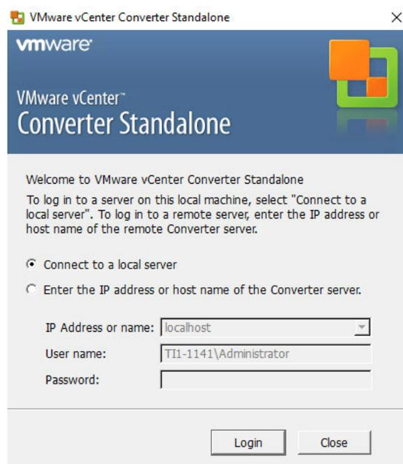
Abbildung 77 - VMware Converter - Verbindungsaufbau zum lokalen oder remote Server
