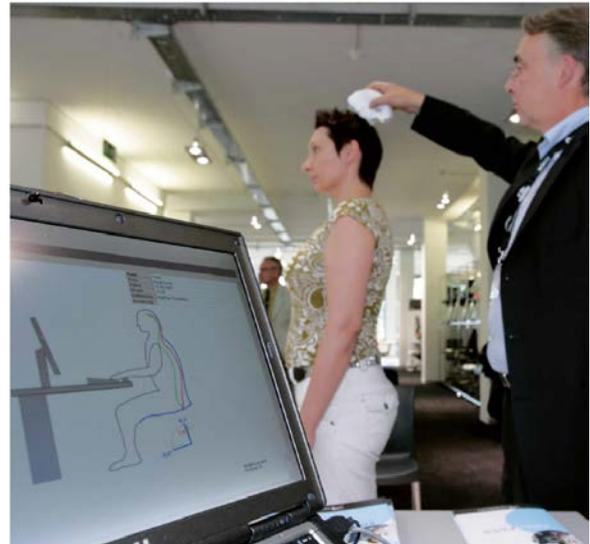
Bei der Ergo - Mouse handelt es sich um ein Messgerät zur optischen Darstellung von Sitzhaltungsprofilen – dabei werden 3 Messungen durchgeführt:
