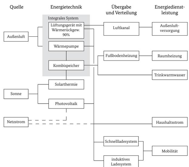
Abb. 14: Beispielhafte Darstellung eines vorab definierten Energieversorgungskonzeptes
