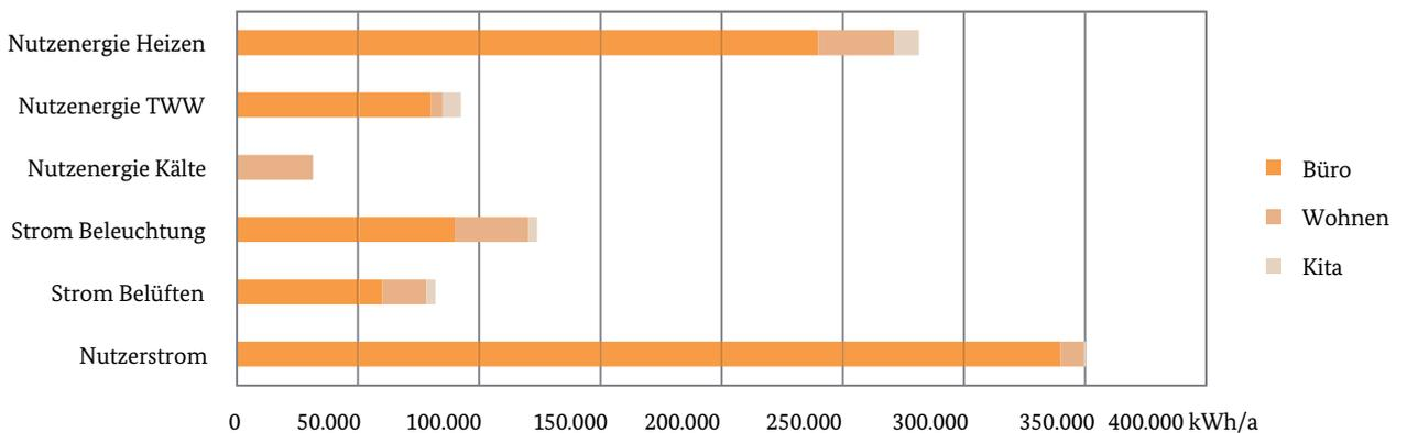
Abb. 18: Beispielhafter Endenergiebedarf einer Mischnutzung (Büro, Wohnen, Kita) mit 16.000 m<sup>2</sup>
