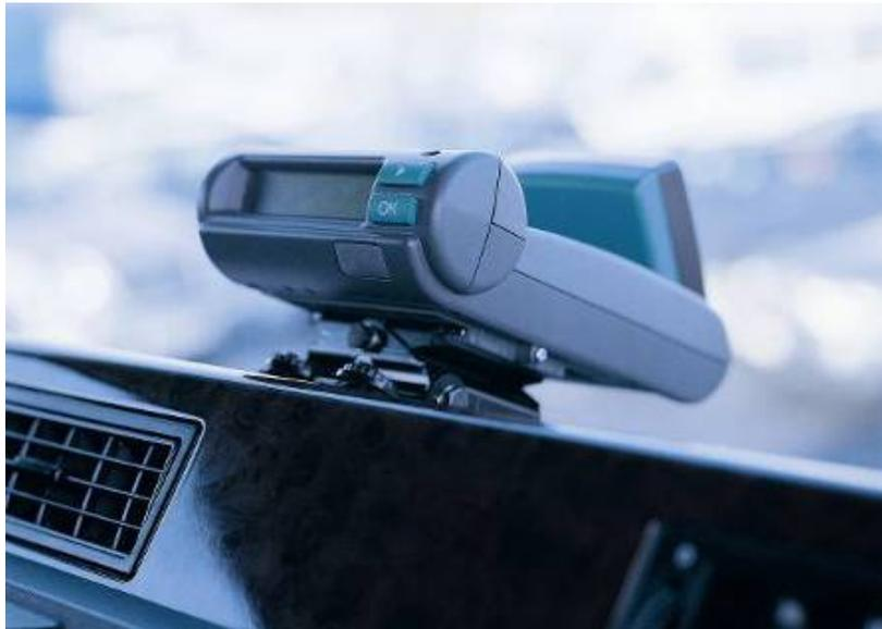
**Abbildung 35: Fahrzeuggerät im deutschen Lkw-Mautsystem (Quelle: Toll Collect GmbH)**
